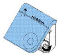
5. Uždékite viršutinę jutiklio dalį, vėl uždédami spaustukus ir spausdami, kol jie užsifiksuos.
