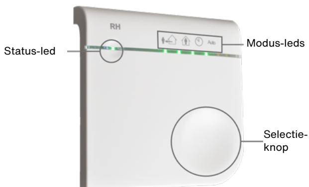
Voorzie de sensor van stroom door er twee AA-batterijen in te plaatsen. Alle leds blijven drie seconden branden. Wacht tot de status-led aangeeft dat de koppelingsmodus actief is.
