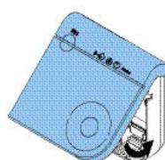
5. Riposizionare la sezione superiore del sensore, riposizionando le clip e premendo finché non si incastri.
