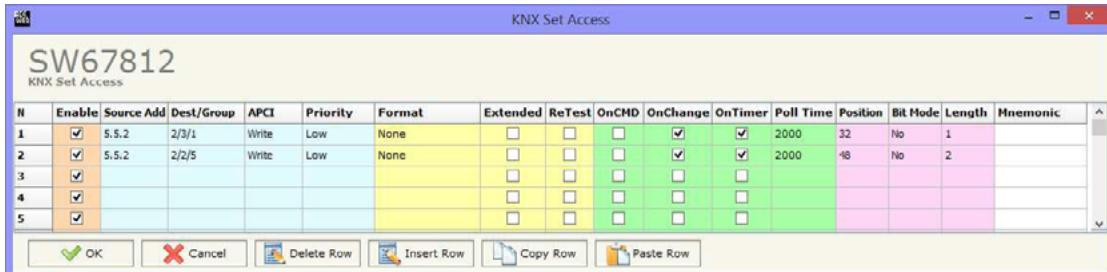
Piezīme: Ja ir atzīmēts lauks "On Change" (Pie izmaiņām) un "Poll Time" (Aptaujas laiks) nav vienāds ar 0, disks sūta KNX komandu cikliski un arī tad, kad mainās dati. Ja lauki "OnCMD", "OnChange" un "OnTimer" nav atzīmēti, pārveidotājs tikai nosaka kopni, lai uzraudzītu KNX ziņojuma statusu.
