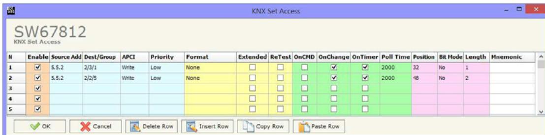
Märkus: Kui välj "On Change" on märgitud ja "Poll Time" ei ole võrdne 0-ga, saadetakse KNX-käsk tsüklikliliselt ja ka andmete muutmisel. Kui väljad "OnCMD", "OnChange" ja "OnTimer" ei ole märgistatud, tuvastab seade ainult KNX-sõnumi staatuse jälgimiseks bussis.
