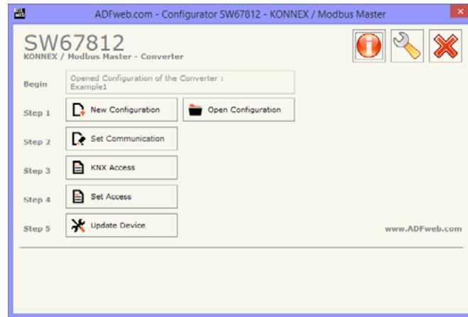
Nospiediet "New Configuration", lai izveidotu mapi, kurā ir ierīces konfigurācija.
