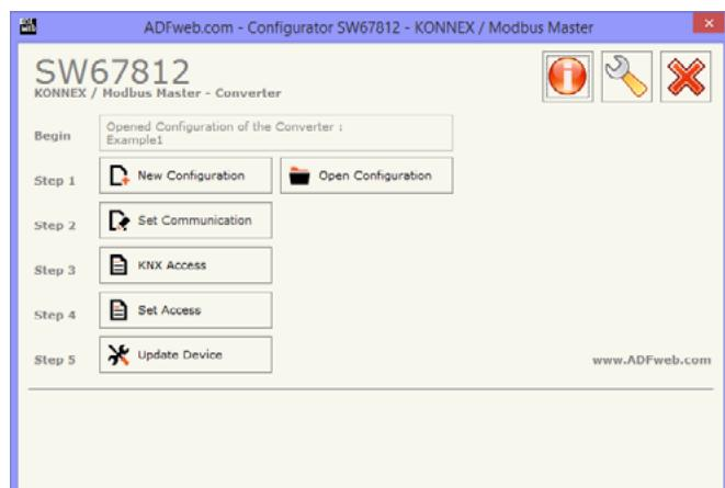
Vajutage "New Configuration", et luua kaust, mis sisaldab seadme konfiguratsiooni.
