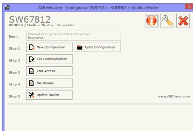
Premendo "New Configuration" viene creata la cartella che contiene la configurazione del dispositivo.
