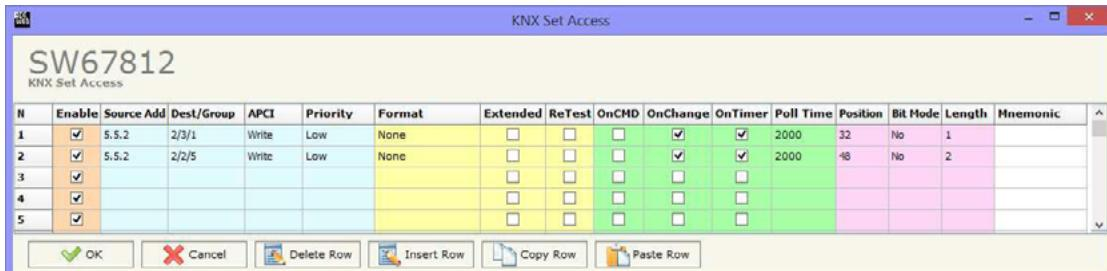
Nota: Se il campo "On Change" è contrassegnato e il "Poll Time" è diverso da 0, l'azionamento invia il comando KNX ciclicamente e anche quando i dati vengono modificati. Se i campi "OnCMD", "OnChange" e "OnTimer" non sono contrassegnati, l'inverter rileva il bus solo per monitorare lo stato del messaggio KNX.
