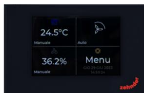
Ventilācijas iekārta pēc noklusējuma izmanto minimālo ventilatora ātrumu. Multi Control, izmantojot tajā iebūvētos relejus, aktivizē otro un trešo ventilatora ātrumu, ja to pieprasī lietotājs vai ja tas nepieciešams pēcapstrādes vajadzībām.
