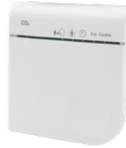
Il sensore wireless di CO<sub>2</sub> rileva il livello di anidride carbonica nell'aria all'interno dell'ambiente in cui è posizionato, inviando le sue misurazioni tramite RF (radiofrequenza) all'unità Zehnder EVO. L'unità varia di conseguenza la sua portata, scegliendo il livello appropriato per garantire la qualità dell'aria interna in base alle informazioni trasmesse dal sensore.
