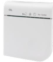
Bezvadu CO<sub>2</sub> sensors uzrauga oglekļa dioksīda līmeni telpā, kurā tas ir novietots, un nosūta rādījumus uz Zehnder EVO ierīci, izmantojot RF (radiofrekvenci). Iekārta attiecīgi maina plūsmas ātrumu, izvēloties pareizo līmeni, lai garantētu iekštelpu gaisa kvalitāti, pamatojoties uz sensora nosūtītajiem datiem.
