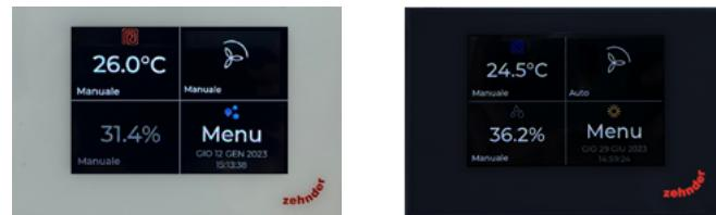
L'unità di ventilazione usa come velocità di base la minima, Multi Control, tramite i relè in esso contenuti, attiva la seconda e la terza velocità quando desiderato o quando necessario per soddisfare le esigenze di post trattamento.
