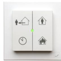
Il comando a pulsante wireless a 4 posizioni EVO Switch comunica tramite RF (radiofrequenza) con l'unità di ventilazione e può scegliere tra quattro diverse modalità di funzionamento. Ha un indicatore di allarme cambio filtro.
