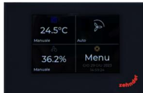
Ventilatsiooniseade võtab vaikimisi minimaalse ventilaatori kiiruse. Multi Control aktiveerib selles sisalduvate releede kaudu teise ja kolmanda ventilaatori kiiruse, kui kasutaja seda valib või kui see on vajalik lisaseadmetest saadud sisendi saavutamiseks.
