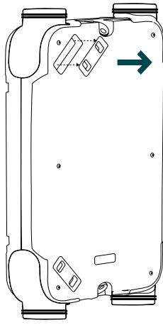
3. Eemalda määrdunud filtri ettevaatlikult, kasutades selleks ette nähtud sakke. Kui kaks filtri ei ole samad, pange tähele nende asukohti: ISO ePM1 filter on paigaldatud õhuvõtu ava juurde ja ISO Coarse filter on paigaldatud väljatõmbeõhu juurde.
