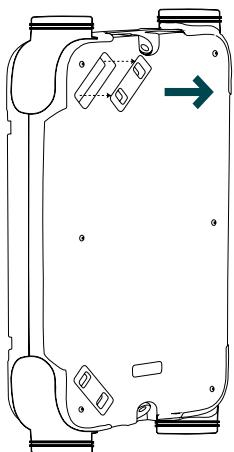
3. Uzmanīgi noņemiet aizsērējušos filtrus, izmantojot tam paredzētās cilpiņas. Ja abi filtri nav vienādi, ņemiet vērā to atrašanās vietas: ISO ePM1 filtrs ir uzstādīts uz āra gaisa ieplūdes atveres, bet ISO rupjais filtrs ir uzstādīts uz telpas gaisa nosūces atveres.
