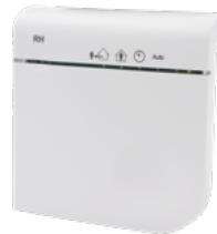
Il sensore wireless rileva l'umidità relativa nell'aria all'interno dell'ambiente in cui è posizionato, inviando le sue misurazioni tramite RF (radiofrequenza) all'unità Zehnder EVO. L'unità varia di conseguenza la portata di ventilazione, scegliendo il livello appropriato per garantire la qualità dell'aria interna in base alle informazioni trasmesse dal sensore.
