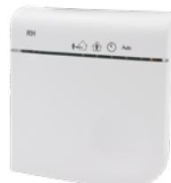
De draadloze sensor bewaakt de relatieve luchtvochtigheid in de ruimte waar hij is geplaatst en stuurt de meetwaarden via RF (radiofrequentie) naar de Zehnder EVO-unit. Het apparaat past het ventilatiedebiet hierop aan en kiest op basis van de door de sensor verzonden gegevens het juiste niveau voor een goede luchtkwaliteit binnenshuis.
