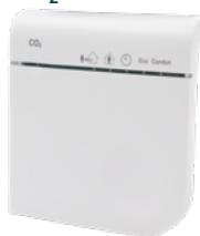
Le capteur de CO<sub>2</sub> sans fil surveille le taux de dioxyde de carbone relevé dans la pièce où il est monté et il transmet ses relevés par RF (radiofréquence) à l'unité Zehnder EVO. L'unité se fonde sur les données transmises par le capteur pour porter en conséquence son débit de ventilation au niveau adéquat dans le but de garantir un air intérieur de bonne qualité.
