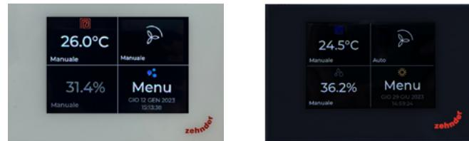
De ventilatie-unit neemt standaard de minimale ventilatorsnelheid aan. Via de aanwezige relais activeert Multi Control de tweede en derde ventilatorsnelheid wanneer de gebruiker dit vraagt of wanneer dit nodig is voor de nabehandelingsbehoeften.
