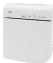
Bezvadu CO<sub>2</sub> sensors uzrauga oglekļa dioksīda līmeni telpā, kurā tas ir novietots, un nosūta rādījumus uz Zehnder EVO ierīci, izmantojot RF (radiofrekvenci). Iekārtā attiecīgi maina plūsmas ātrumu, izvēloties pareizo līmeni, lai garantētu iekštelpu gaisa kvalitāti, pamatojoties uz sensora nosūtītajiem datiem.
