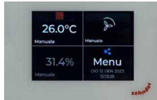
Ventilatsiooniseade võtab vaikimisi minimaalse ventilaatori kiiruse. Multi Control aktiveerib selles sisalduvate releede kaudu teise ja kolmanda ventilaatori kiiruse, kui kasutaja seda valib või kui see on vajalik lisaseadmetest saadud sisendi saavutamiseks.
