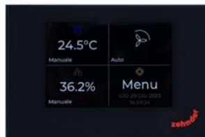
Ventilācijas iekārta pēc noklusējuma izmanto minimālo ventilatora ātrumu. Multi Control, izmantojot tajā iebūvētos relejus, aktivizē otro un trešo ventilatora ātrumu, ja to pieprasī lietotājs vai ja tas nepieciešams pēcapstrādes vajadzībām.
