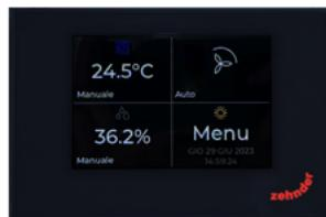
La vitesse minimale de rotation du ventilateur est sélectionnée par défaut sur l'unité de ventilation. Les relais dont le dispositif Multi Control est équipé autorisent l'activation de la seconde ou de la troisième vitesse de ventilation à la demande de l'utilisateur ou lorsque leur sélection s'impose pour répondre aux besoins de post-traitement.
